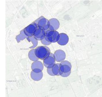
LT restwarmtebronnen: Waaronder voornamelijk - datacenters; - RWZI Harnaschpolder Totale potentie voor Delft 380 TJ
