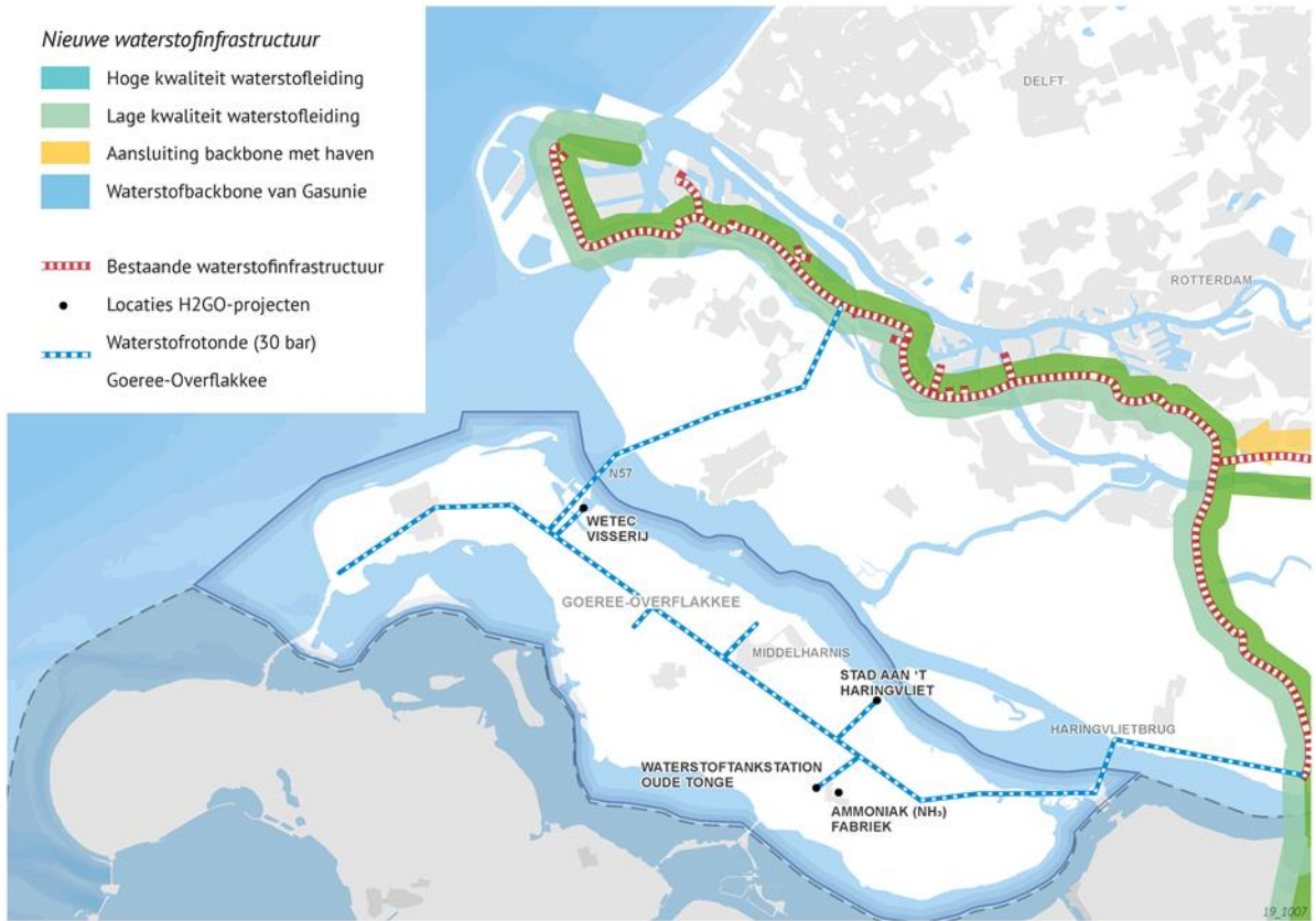
Figuur 18: Waterstofleidingnetwerk op Goeree-Overflakkee
