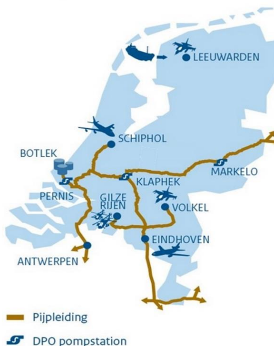
Figuur 16: Nederlandse defensiepijpleidingnetwerk
