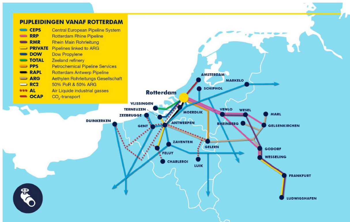
Figuur 17: Pijpleidingen vanaf Rotterdam voor transport van olie, olieproducten en gassen (AT Osborne, September 2018)
